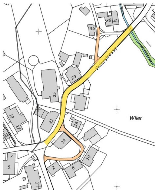
Die Wilerstrasse sowie die zum Projekt gehörenden Ring- und Püntstrasse befinden sich in einem schlechten Zustand. Risse, Netzrisse, Belagsflicke und Setzungen lassen auf eine qualitative Schwächung der bestehenden Strassenoberfläche schliessen. Ebenso sind die bestehenden Strassenabschlüsse durchwachsen und in einem schlechten Zustand. Eine Zustandserfassung ergab im März 2023, dass voraussichtlich auch ein Teil der Fundationschicht ersetzt werden muss.
